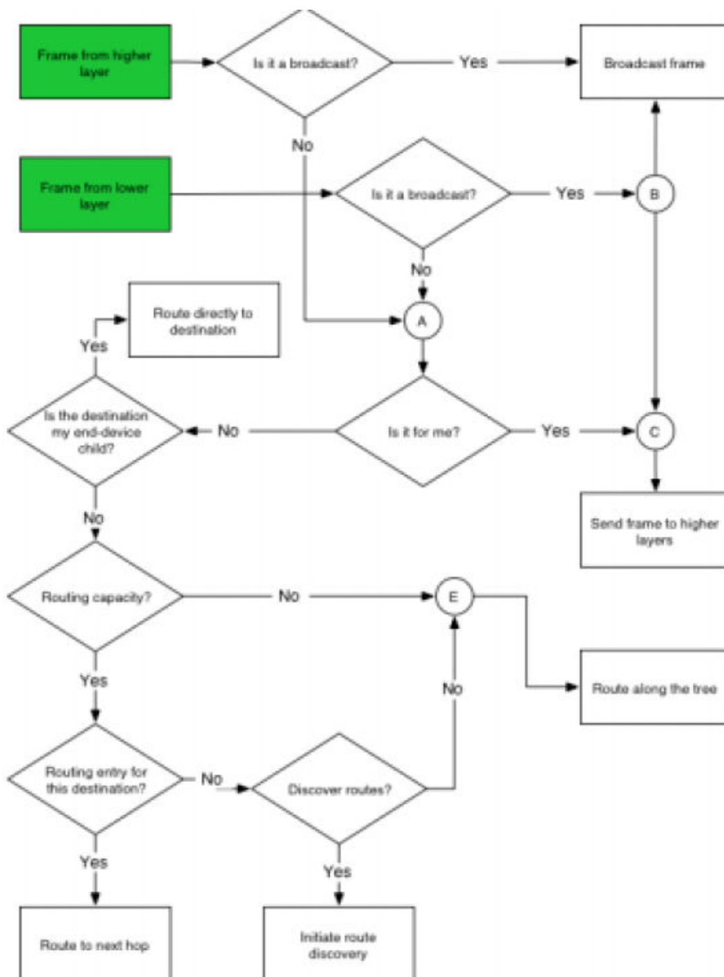
圖 21 ZigBee 的基本路由演算法
